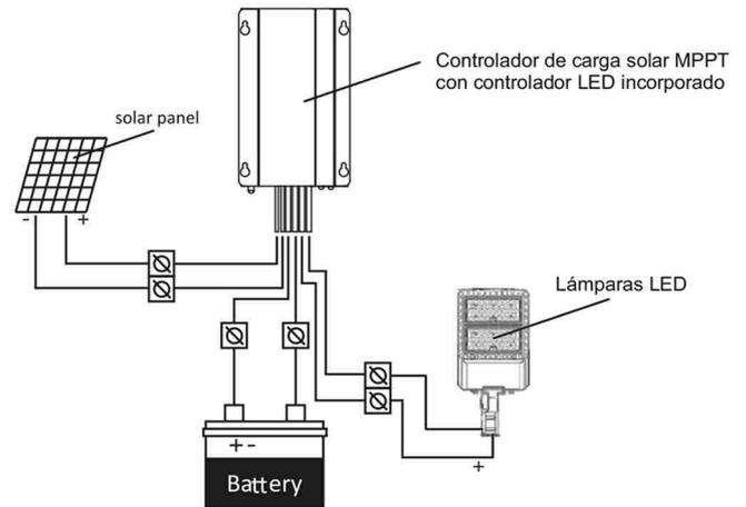
Un conjunto completo de farola solar incluye lámpara, Batería, panel, controlador, poste, cable, etc.
